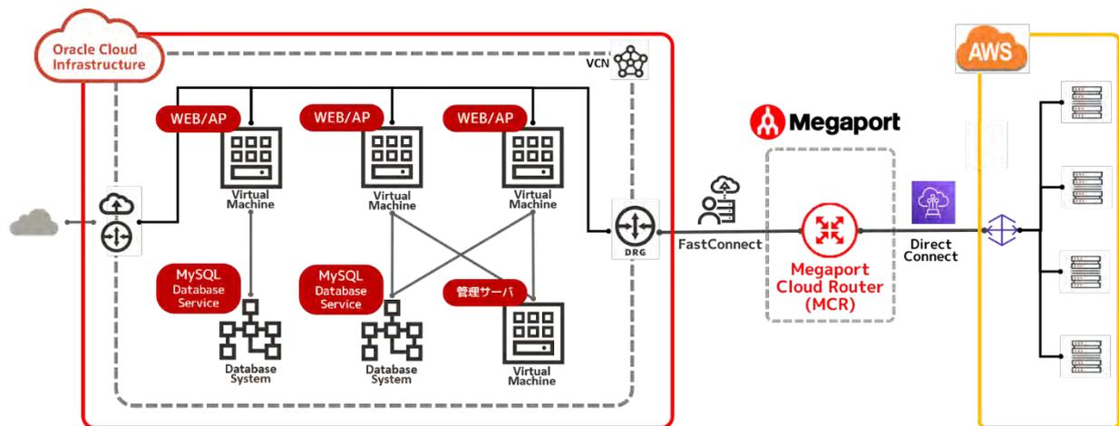
パソナテックは、社内システム基盤としてAmazon Web Service(以下 AWS)を採用していました。課題であったクラウドのコスト増やBCP対策の観点より、コンテンツ管理システム(CMS)のリプレイスに合わせてAWSからOCIへの移行を実施し、Megaport社のクラウド接続サービスを活用。
